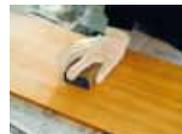
最初は粗めの#120~180程度のサンドペーパーで荒削りして、最後に#320程度のサンドペーパーで表面を滑らかにします。
