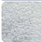
凹部に塗料が入りきらず塗れていない部分が残る
